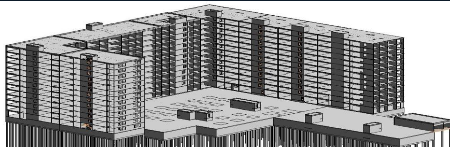
3D-модель несущих конструкций
